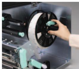
ラベル装填は、一方のリールを軽く押すだけでラベルをセンターにセットできます。
