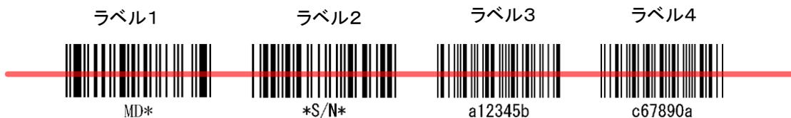
データ間には、データの区切り記号としてセパレータを設定できます。セパレータは、最大 4 桁の文字を設定できます。
