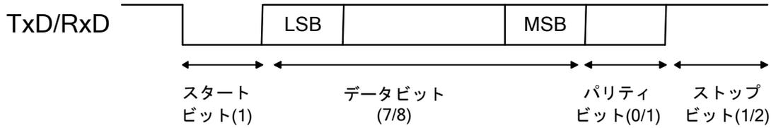
データビット、パリティビット、ストップビットは、下記のメニュー / コマンドにより設定できます。キャラクタフォーマットのコマンドによる設定は、“Z2” (コマンド不揮発性メモリへの書き込み) と併用して使用します。
