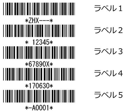
また、各段との間には、データの区切り記号としてセパレータを設定できます。セパレータは、各ラベル間に最大 4 桁の文字が設定できます。
