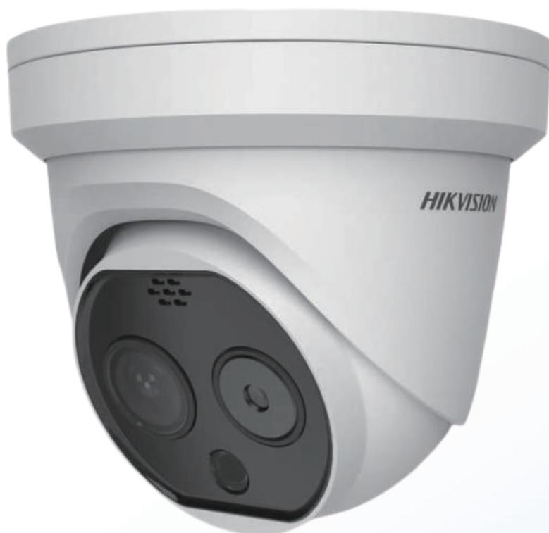
ドーム型サーモグラフィカメラは、AI顔認識機能で物体の表面温度を高精度でリアルタイムに測定できます。
