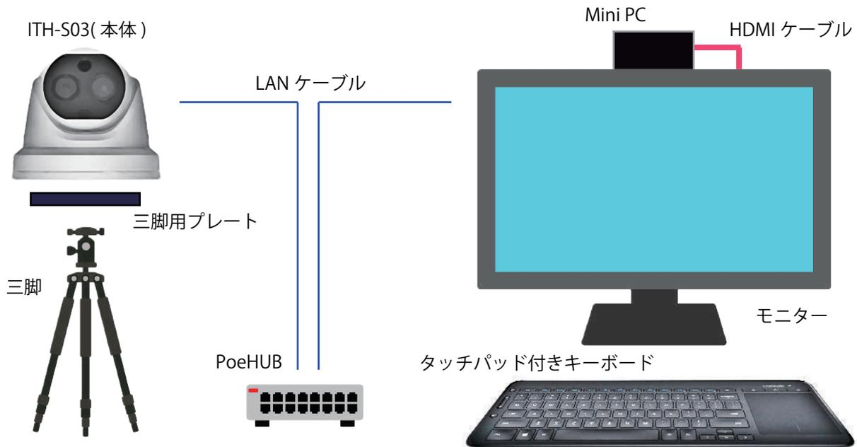
本体、周辺機器すべてセットに含み、計測カメラとPCの基本設定済で出荷いたしますので結線後、直ぐに使用可能です。
