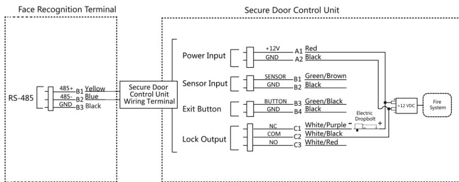
図4-5 ワイヤで固定されたドアコントロールユニット
