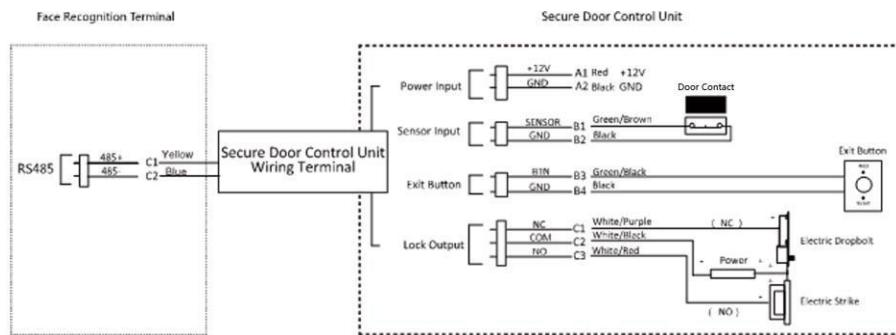
図4-3 安全なドアコントロールユニットの配線
