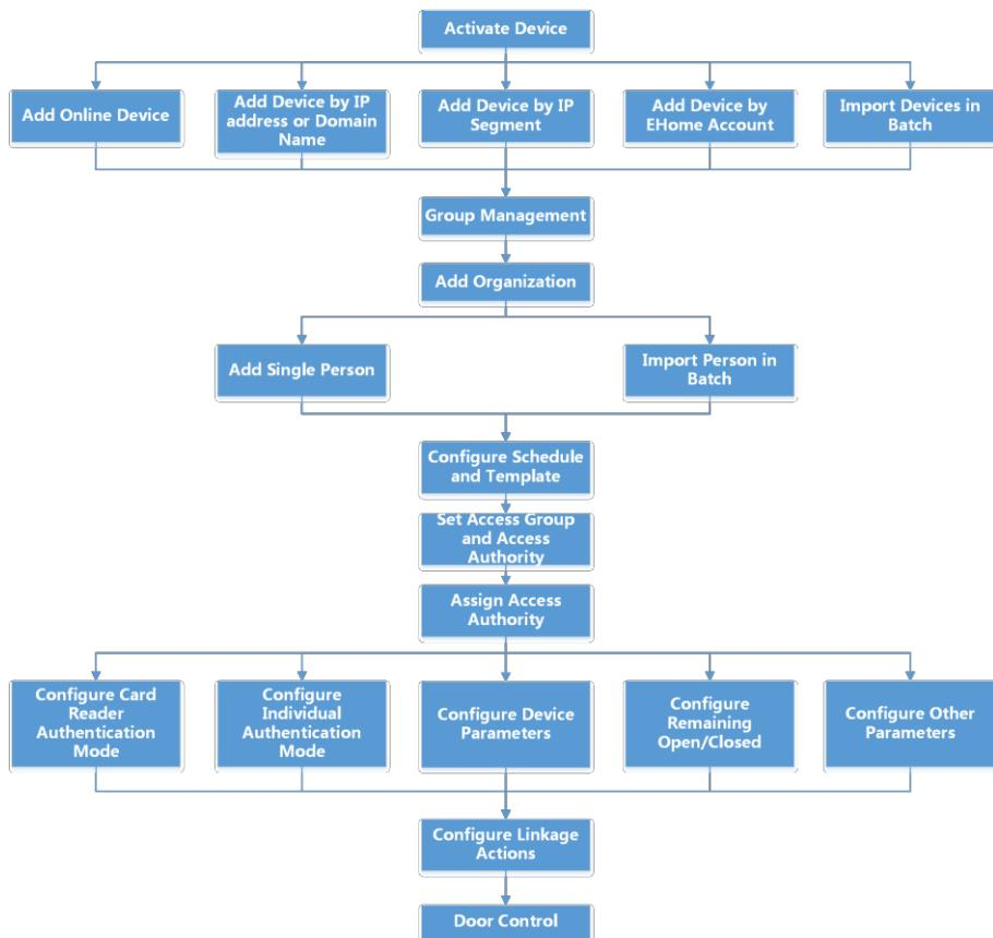
図7-1 クライアントソフトウェアの設定フロー
