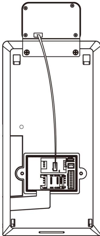
図3-1 サーモグラフィモジュールの接続
