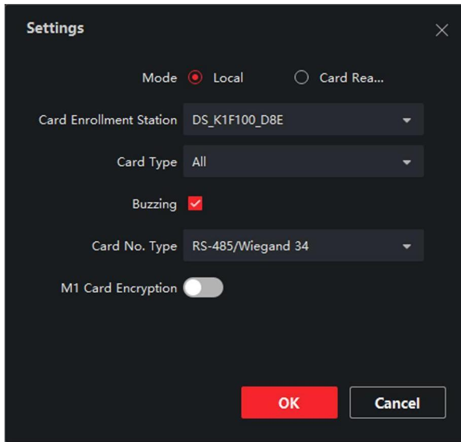
図7-2 ローカルモードによるカードの発行
