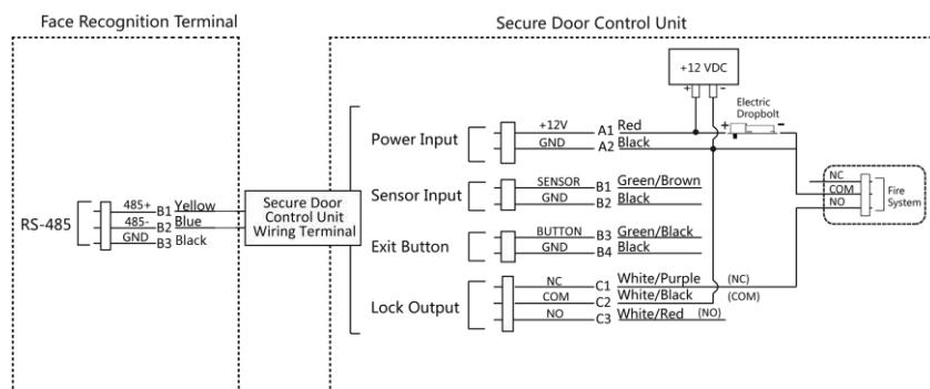
図4-7 安全ドアコントロールユニットの配線
