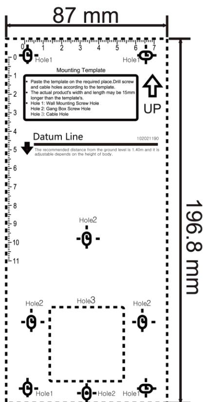
図3-4 テンプレートの取り付け
