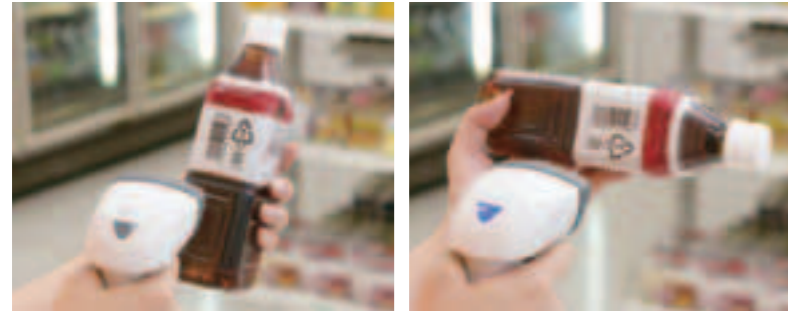
バーコードが縦でも横でも、向きを気にせず高速読み取り。
